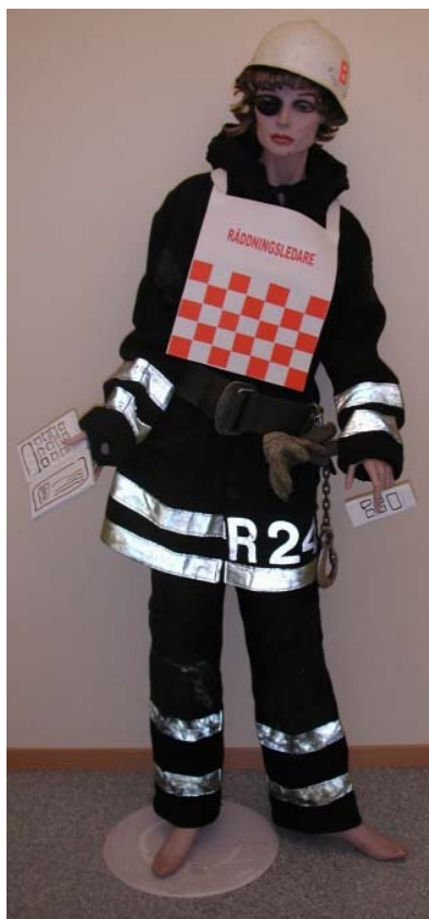
Brandmansmockupen i form av skyltfönsterdocka användes för att visualisera idéer. Här visas hur terminalmockupen (i höger hand) och en stor PTT-knapp (i vänster hand) kan användas.
