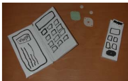
Terminalmockuperna, till vänster den ihopfällbara till höger radio med PTT-knapp
